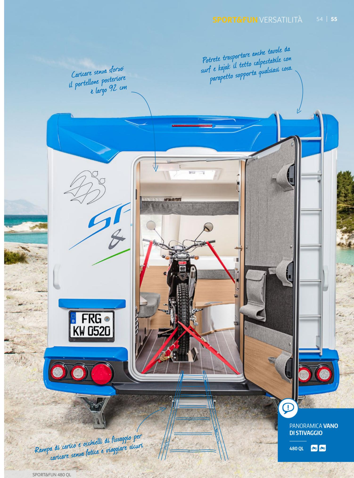
*Rampa di carico e occhielli di fissaggio per caricare senza fatica e viaggiare sicuri*
